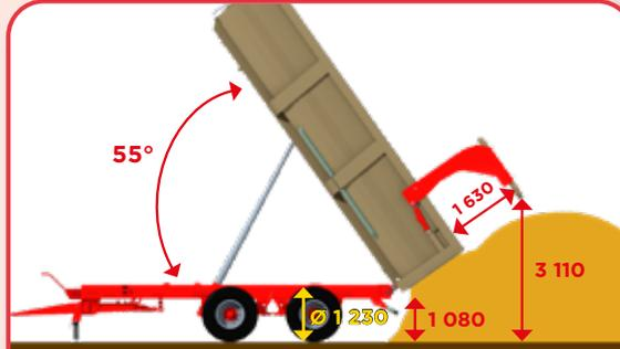
**Puerta trasera de gran despeje con apertura hidráulica** para facilitar la descarga del ensilado con realces y evitar el raspado de la pila durante el vuelco máximo.
